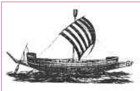
Nave do faraón Ramsés III, ano 1200 a. C. Barco de guerra, xa dotado de esporón na súa proa, idóneo para o ataque. O temón xa vai evolucionando cara ó que será no futuro: unha soa pa. A vela tipo foque, firme ó mastro por unha soa verga, marca a tendencia posterior.
