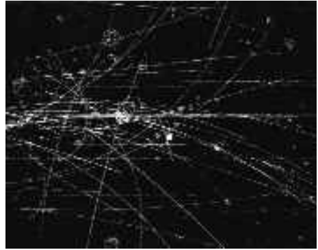
Os grandes aceleradores de partículas permiten o estudo das partículas elementais; estas e as súas interaccións pódense detectar nas cámaras de burbullas como esta do CERN
